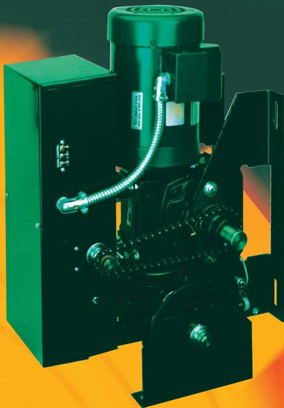
***MGH, opérateur de type mural à réducteur type "roue-vis sans fin" conçu pour un usage intensif des portes industrielles sectionnelles à élévation et surélévation verticale et pour des portes ou des grilles à enroulement. Il s'installe des deux côtés de la porte en mural. Il intègre un palan manuel à chaîne pour la manoeuvre manuelle.***
